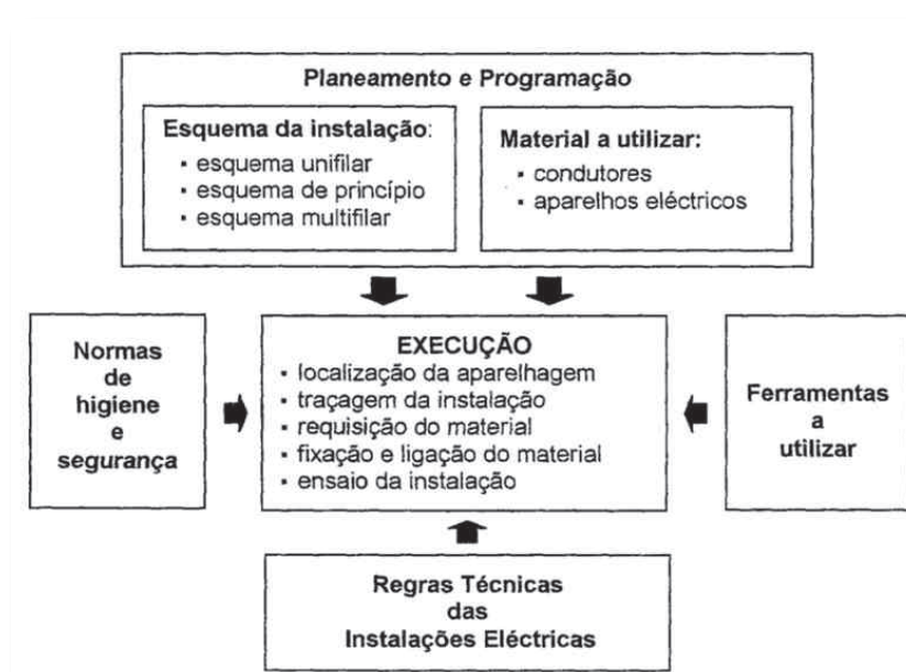
Fig. 60 – Planeamento, programação e execução de circuitos eléctricos
